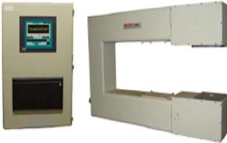
Система измерения толщины горячего и холодного проката, состоит из С-
